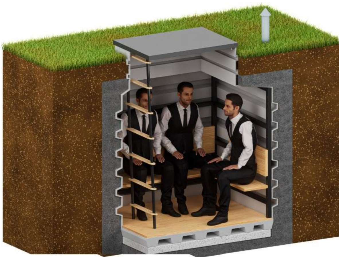
Varna klet-zaklonišče v prerezu: trije nivoji polic, prostor za 2–3 osebe
