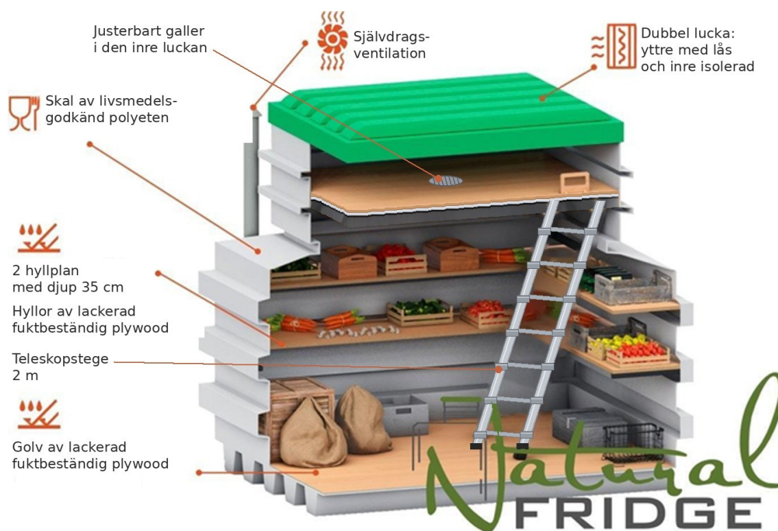
Jordkällaren i genomsnitt: hyllor, teleskopstege, dubbel lucka och ventilation
