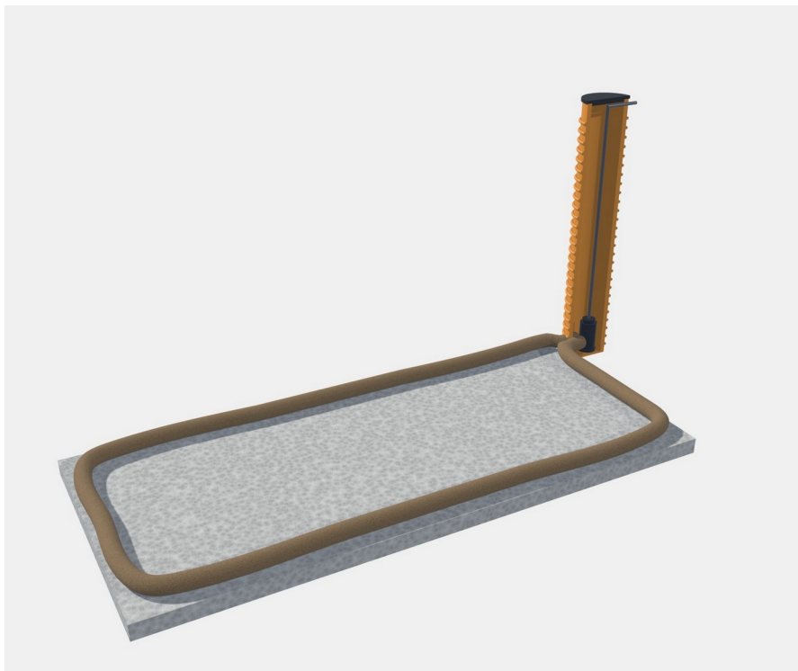
Drenāžas sistēmas shēma: plātne, gredzenveida caurule, aka griezumā, sūknis un spiedvads
