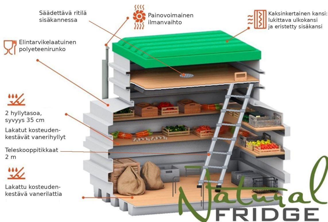
Kellarin leikkaus: hyllyt, teleskooppitikkaat, kaksinkertainen kansi ja ilmanvaihto
