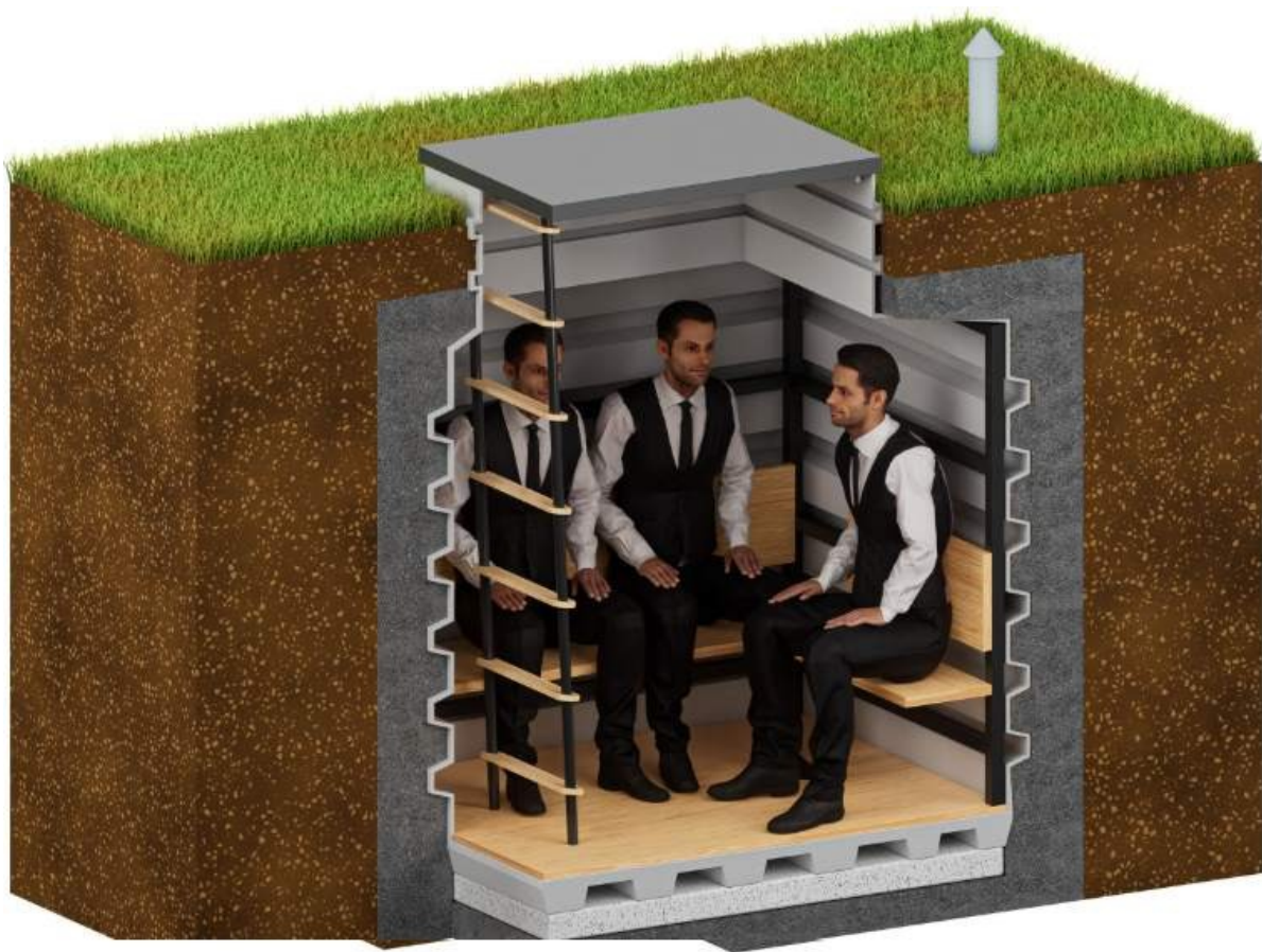
Bezpečný sklep-úkryt v řezu: tři úrovně polic, místo pro 2–3 osoby
